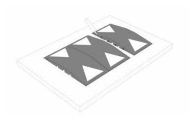
Verklebung der Terrasoft Überfahrrampe auf festem Untergrund und an den Stirnseiten – für einen dauerhafter Einsatz!
