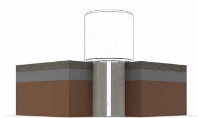
Einfundamentierung des Terrasoft Zylinders mit Hilfe des Bodenankers.
