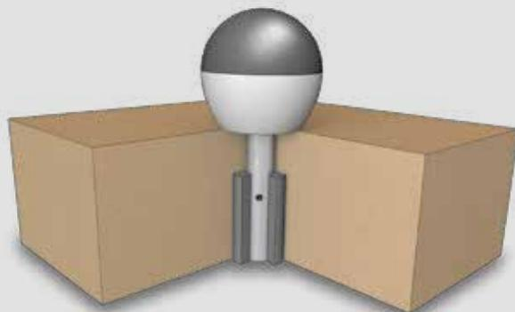
Der Terrasoft Wippendämpfer wird in einem kleinen Betonfundament fixiert.
