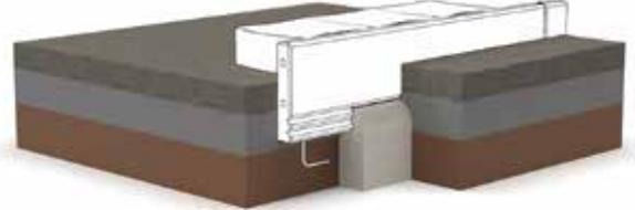
Wegeinfassungen werden mit Hilfe des Bodenankers in einem Betonfundament fixiert.
