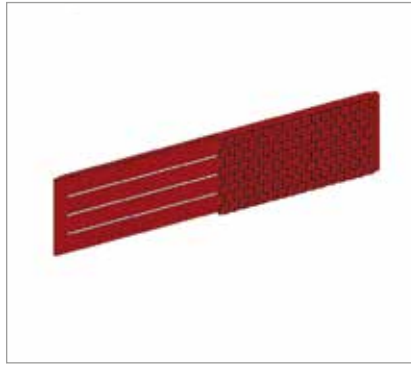
Im Inneren der Schallschutzwand befinden sich Schienen zur Stabilisierung des Gummigranulats.
