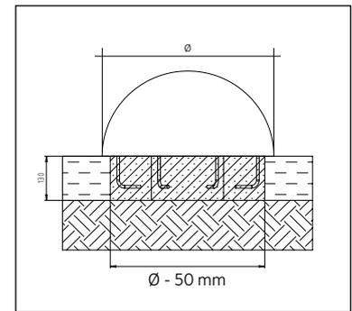
Einfeldamentierung der Terrasoft Halbkugel mit Hilfe des Bodenankers. Das Fundament ist 50 mm kleiner als der Durchmesser der Halbkugel.
