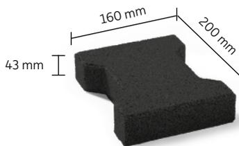
Die formschlüssigen Terrasoft Doppel-T-Steine sind einfach im Verband zu verlegen und auf dem Untergrund zu fixieren. Sie sind aus hochverdichtetem, feinem SBR-Gummigranulat und garantieren ein dauerhaft homogenes Flächenbild. Die einzelnen Steine verzahnen bei der Verlegung ineinander, so dass eine stabile Flächenbefestigung im Verbund entsteht. Die kleinformatischen Steine lassen sich gut in Radien verlegen, haben eine hohe Verbundwirkung und sind für den Einsatz im Außenbereich konzipiert.
