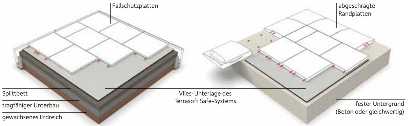
Das Terrasoft Safe System wird mittels Steckverbinder formschlüssig verbunden und im Halbverband auf dem Kunststoffgewirr verlegt.
