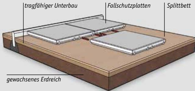
Verlegung (Halbverband) auf sickerfähigem Untergrund (Lava, Basalt, Schotter, Splitt) mit Einfassungselement und Systemsteckern.
