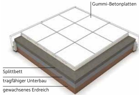
Die Terrasoft Gummi-Betonplatten können im Halbverband oder in Kreuzfuge in einem Splittbett verlegt werden.
